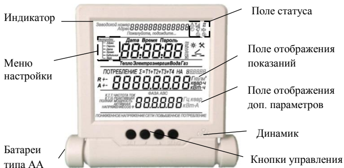
Рисунок В.1 – Внешний вид индикаторного устройства
