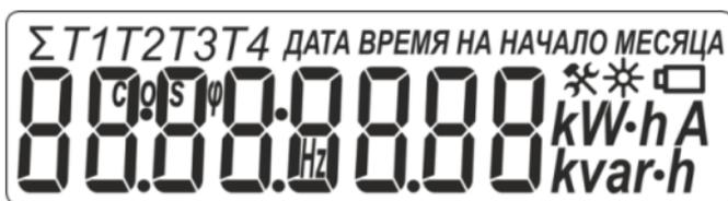
Рисунок 3.1 – Режим теста ЖКИ счетчика
