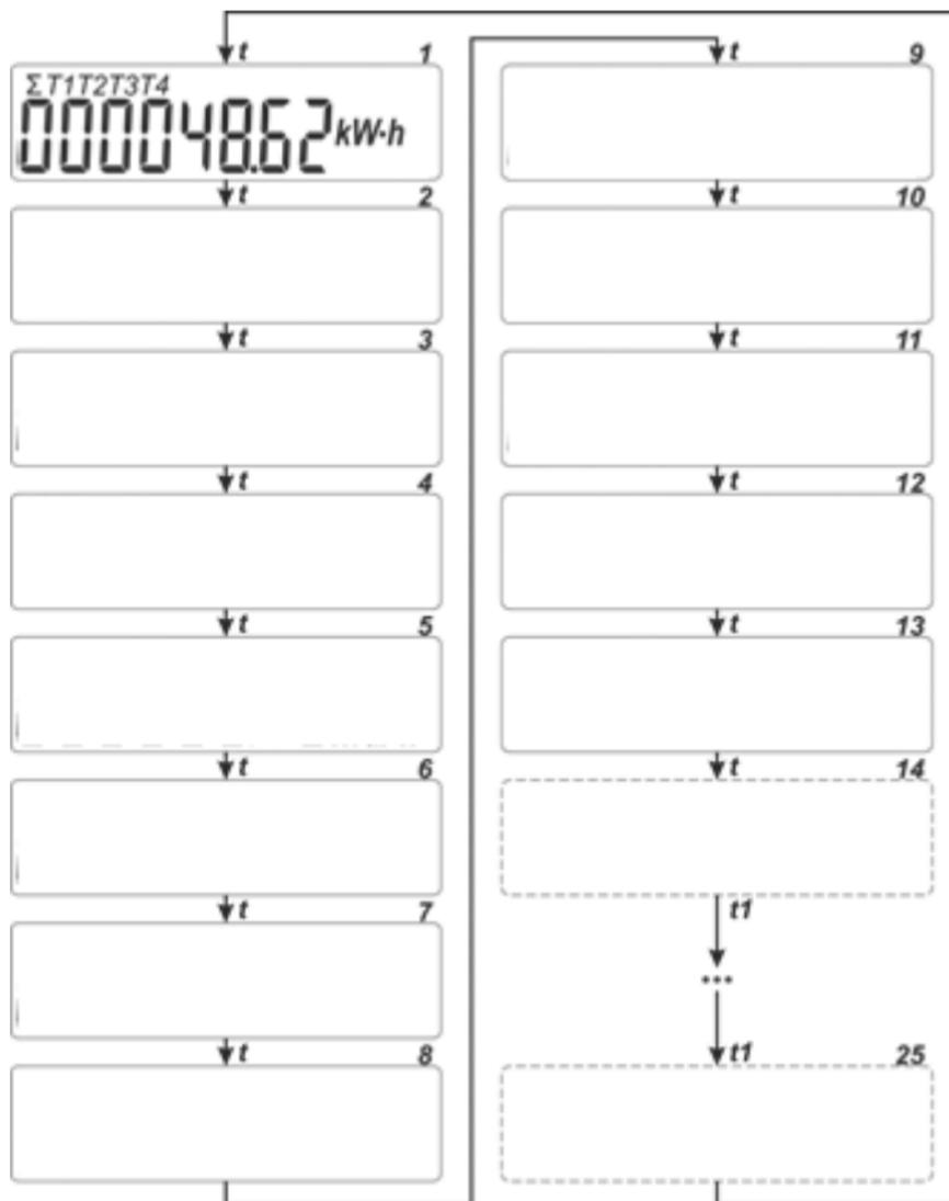
Рисунок В.1 – Режимы циклической индикации счётчика
