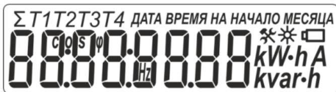
Рисунок 1.1 – Общий вид дисплея счётчика.
