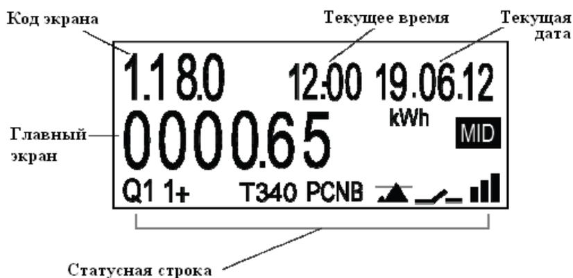
Рисунок 1.1 Структура данных ЖК дисплея счетчика ST 1000-6
