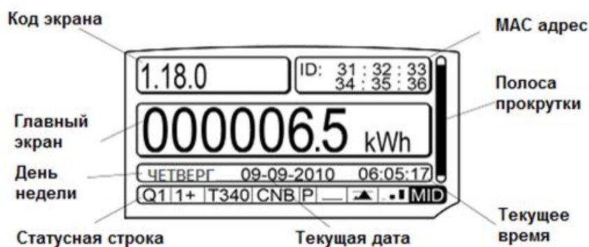
Рисунок 1.1 Структура данных ЖК дисплея ST 2000-9
